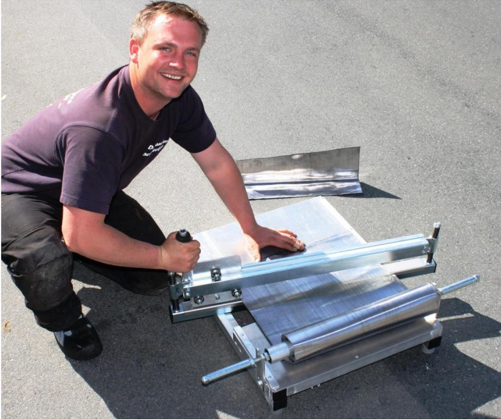
Dachdecker Arik Barciaga aus Haltern am See bei der Arbeit mit dem Walzbleischneider
